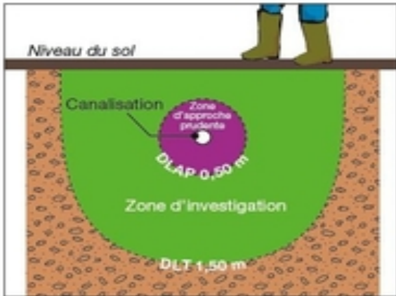
Figure 7. Canalisation isolée enterrée.
